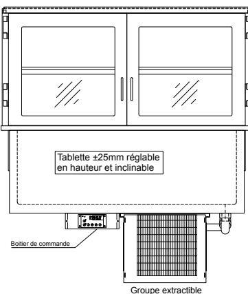
**GREEN FRESH SELF• Vitrage oblique LS + portes arrières - HAUTEUR STRUCTURE 550 MM**
