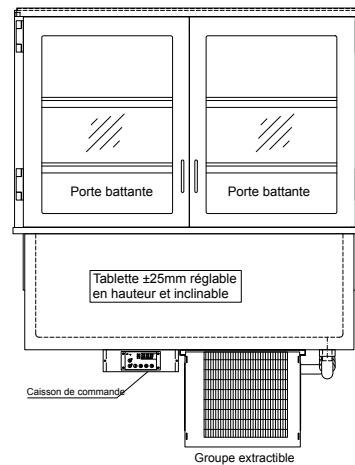
**GREEN FRESH SELF• Vitrage oblique LS + portes arrières - HAUTEUR STRUCTURE 720 MM**
